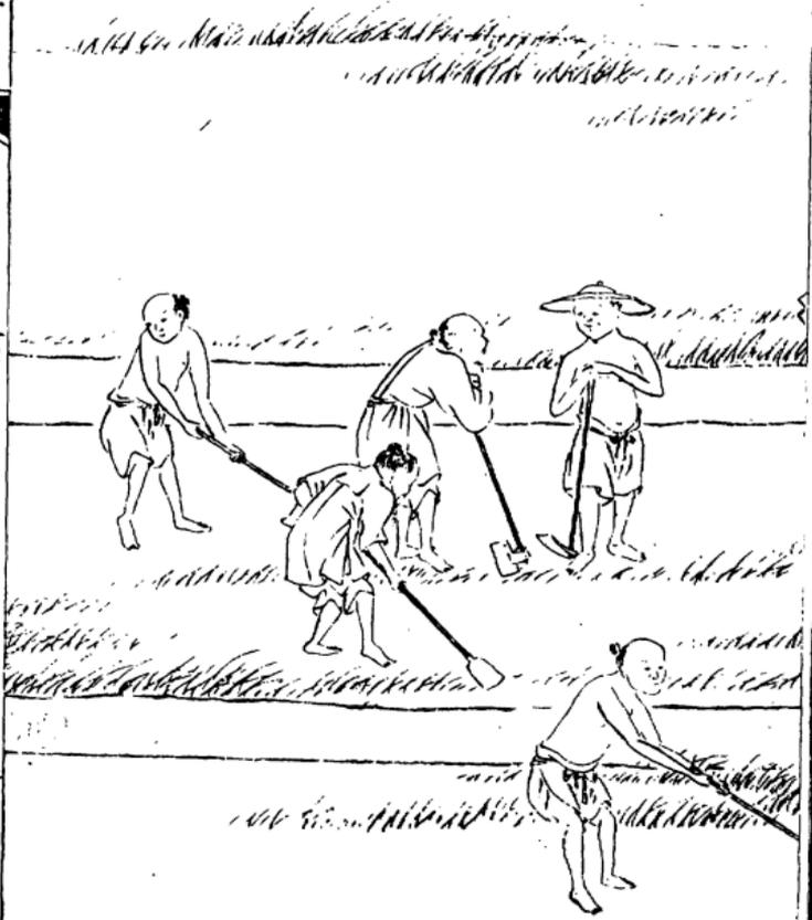
削土取平 潮浸既久又須日晒土乾工丁不問老幼各用扒鋤頭剗去細草分為片段以一淋為率或三片四片於中及四圍通開淺淺小渠引水而已却就港邊做潢頭每日棹水自港頭放入小渠分流四圍以供早晚澆潑其場地宛如鏡面光淨四下坦平方可攤灰晒之如有凹凸遇雨則凹處遲乾潑水則凸處不積
